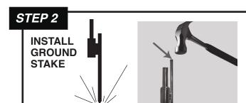
HAMMER ON THE TOP OF THE MAIN PART OF THE STEEL ROD TO INSTALL THE GROUND SPIKE.
